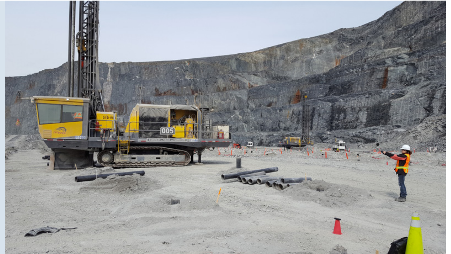
▲ Mesure du bruit sur une foreuse Pit Viper à l'aide d'un appareil portable Concerto
