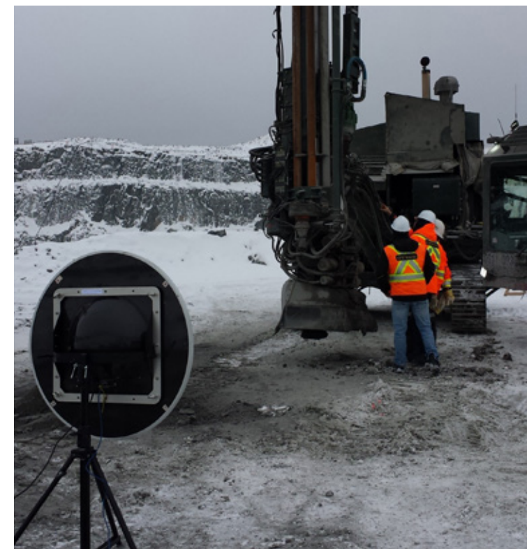
▲ Mesure du bruit sur une foreuse en conditions hivernales
