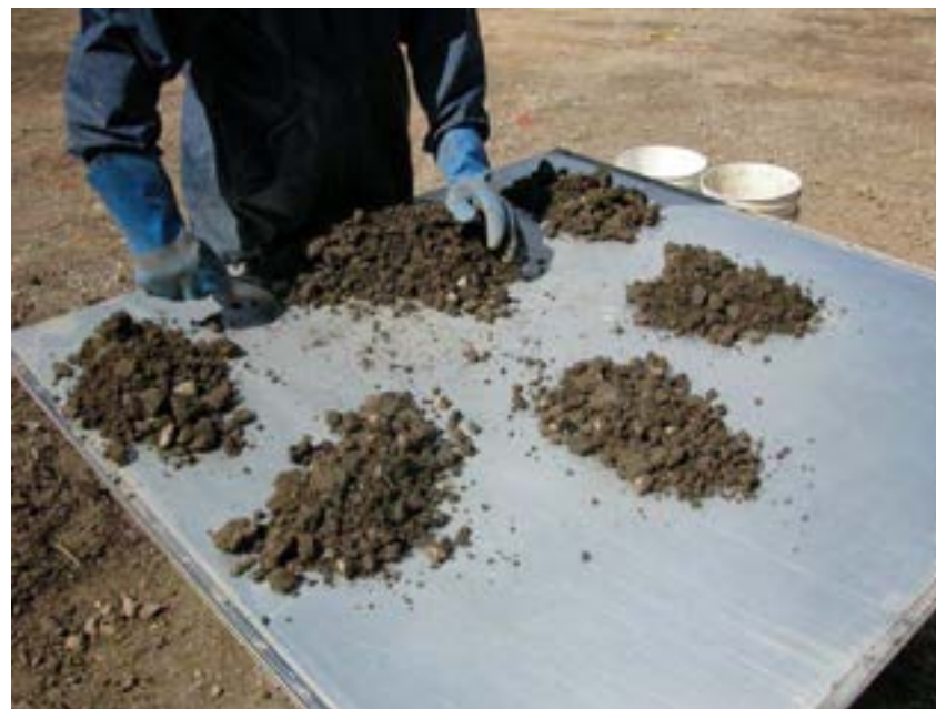
Réduction de masse de l'échantillon primaire par pelletage fractionné
